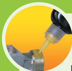
Les résines anaérobies d'étanchéité des raccords LOCKTOP remplacent l'usage des filasses, pâtes à joints et autres rubans dans l'étanchéité des raccords utilisés dans les systèmes hydrauliques, pneumatiques, gazeux et aqueux... Elles assurent une parfaite étanchéité entre les filets tout en agissant comme lubrifiant et pâte anti-grippante.
