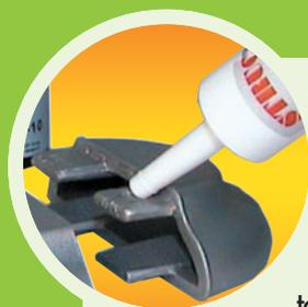
Adhésif réactif bi-composant sans mélange à base de méthacrylates à polymérisation très rapide, permettant de coller virtuellement tous les matériaux pour des jeux allant jusqu'à 0,8mm. Il remplace les méthodes conventionnelles d'assemblage (soudage, vissage, rivetage).
